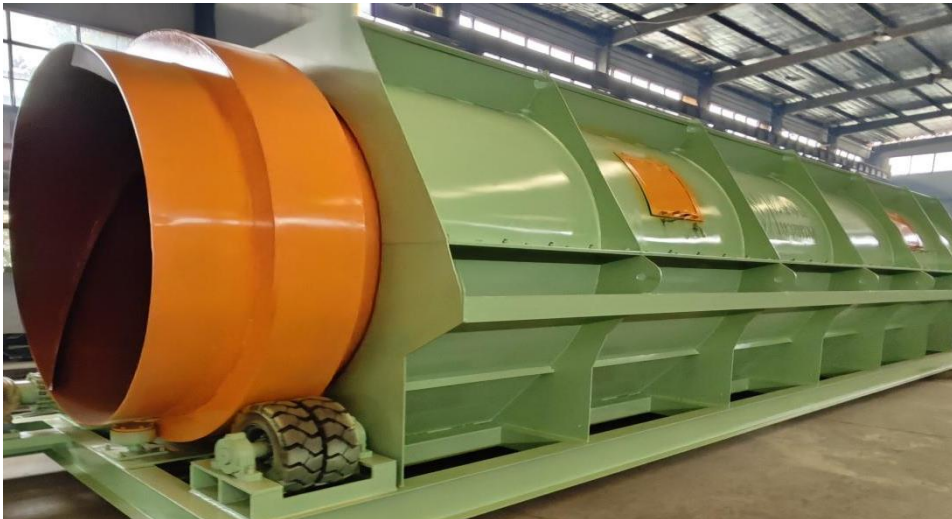
滚筒筛承重托轮均采用实心工业级橡胶轮胎(上图) 所有设备均采用国标铜线绝缘线圈
