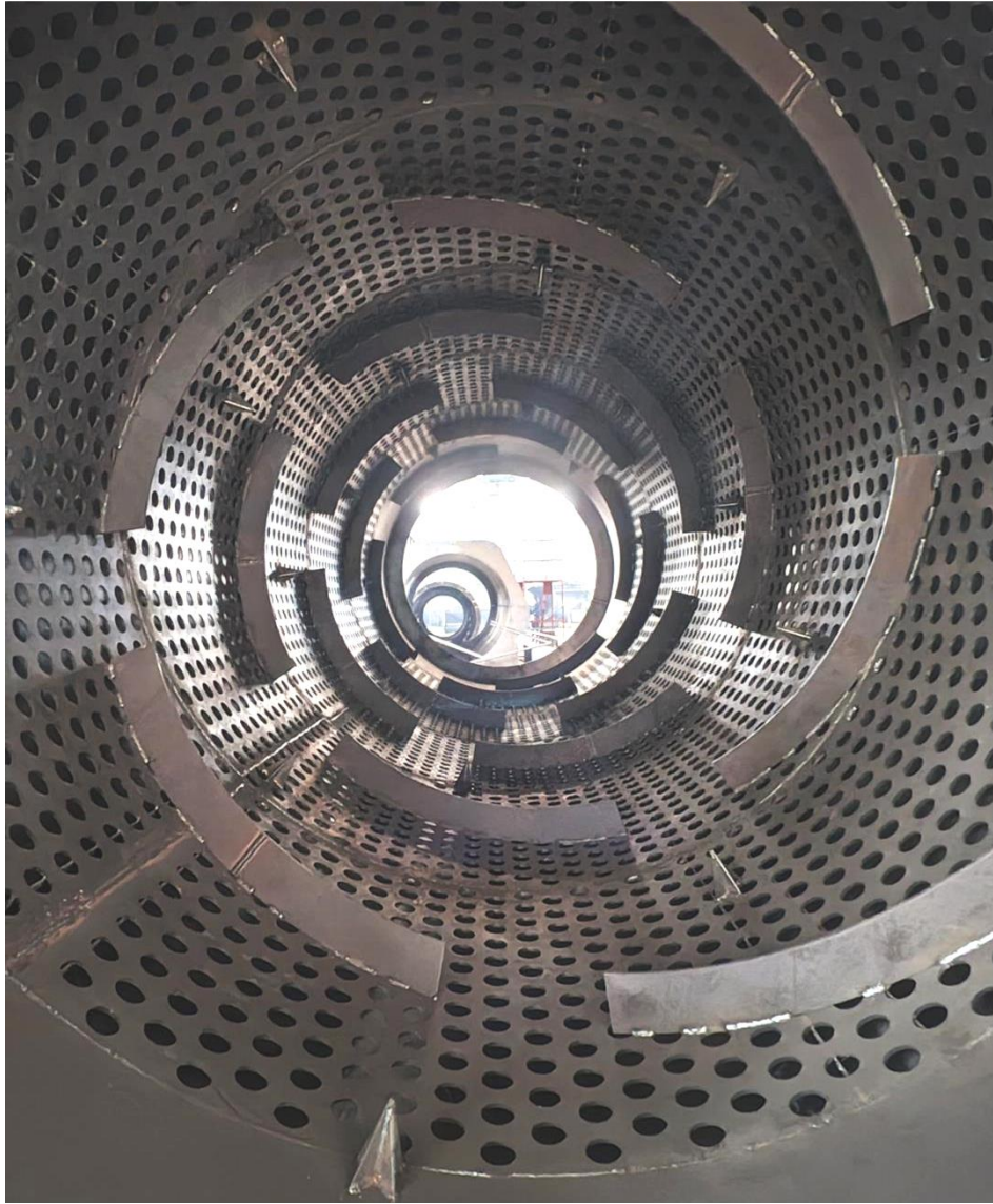
滚筒筛外壁加装清扫装置 防堵孔（上图）
