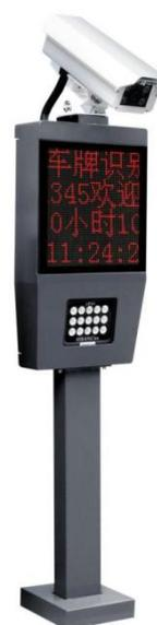
设备采内嵌的识别软件包含了视频采集、图像预处理、车辆检测、车牌识别、图像压缩、数据传输等模块。系统识别速度快，可靠性高，特别是独特的移动物体跟踪和比对技术可以将帧间有效信息充分利用起来，不依赖单张图片，有效提高系统的识别精度和对复杂环境的适应能力。
